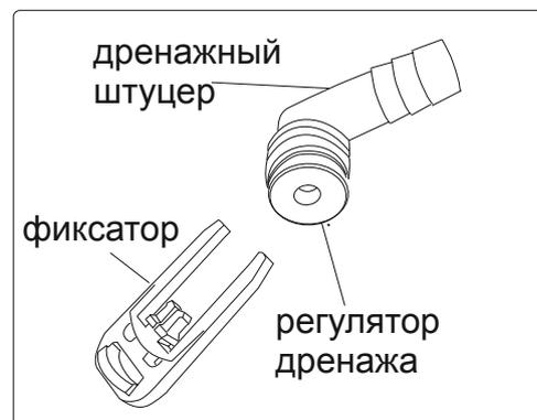
Подсоедините дренажную трубку с внутренним диаметром 16 мм к дренажному штуцеру. Вставьте дренажный штуцер в сливное отверстие клапана. Дренажная трубка должна иметь жесткое соединение со штуцером с помощью стягивающего хомута. Сама трубка должна быть достаточно эластичной и не иметь перегибов.
